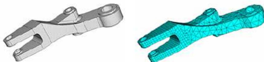
Figura 2- 9. Geometría y Mallado por Elementos Finitos.
