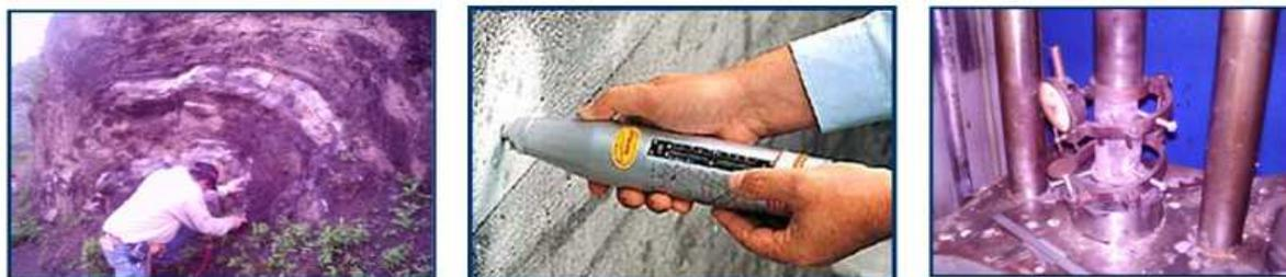
Figura 2- 18. Toma de muestras, medición con esclerómetro in situ y ensayo de compresión uniaxial, Imágenes tomadas de Quintero y Elberg [46].
