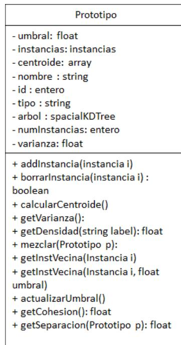
**Figura A.4.** Diagrama de clase del objeto Prototipo.
